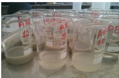
Figura 4- Coleta da Fração Argila em Suspensão
