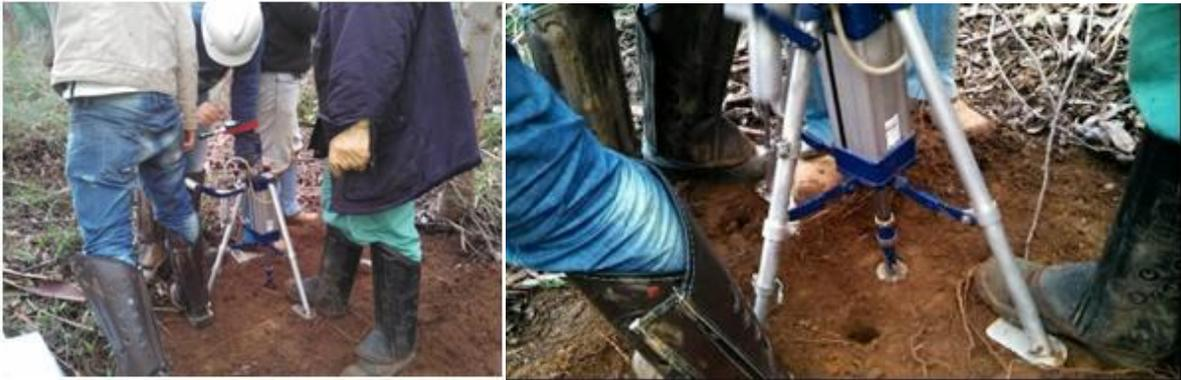
Figura 1. UP 54C226, Fazenda Santana. Detalhes do ensaio de resistência do solo ao cisalhamento realizado in situ.
