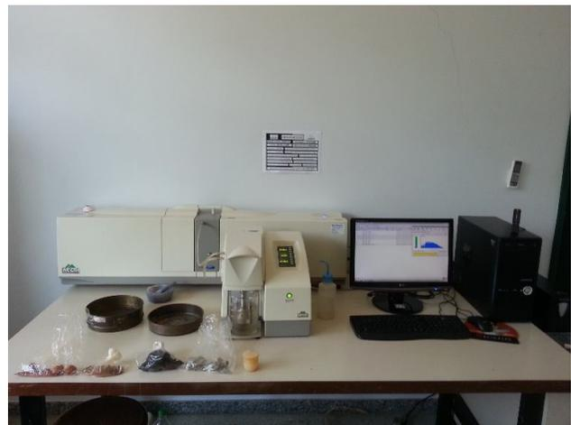
Figura1: Granulômetro a laser Malvern - Mastersizer 2000.
