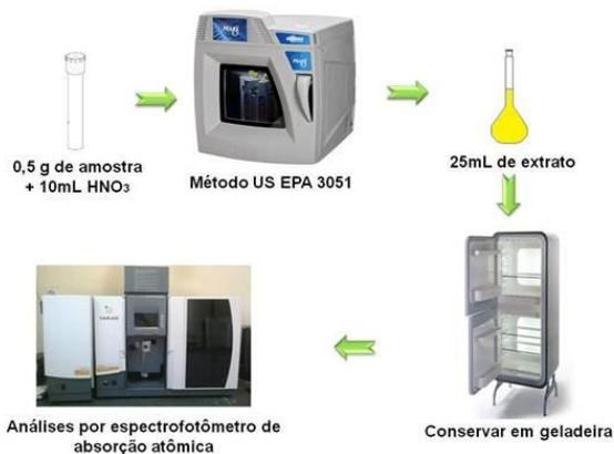
**Figura 1.** Sequência de etapas da digestão por forno de micro-ondas.
